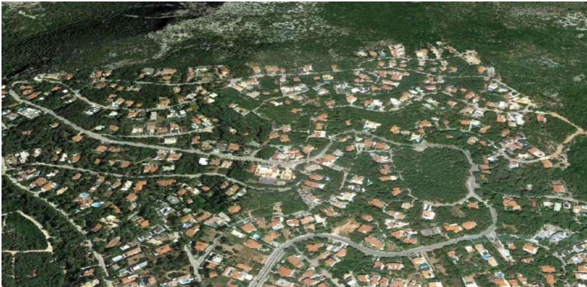
Εικόνα 11.2. Δομημένη περιοχή που κατά το παρελθόν έχει αναπτυχθεί εντός δάσους ή δασικής έκτασης και τα κτίσματα που την συγκροτούν έχουν μεγάλη εγγύτητα με καύσιμα δασικής προέλευσης.
